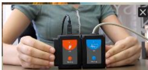
Fig.7. Asigurarea conectării senzorului NUL-218 la modulul USB-200.
