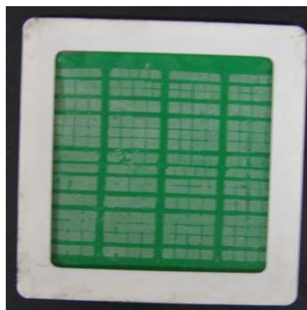
**Рис.2.** Композиционный слой, нанесённый сеткографическим методом.
