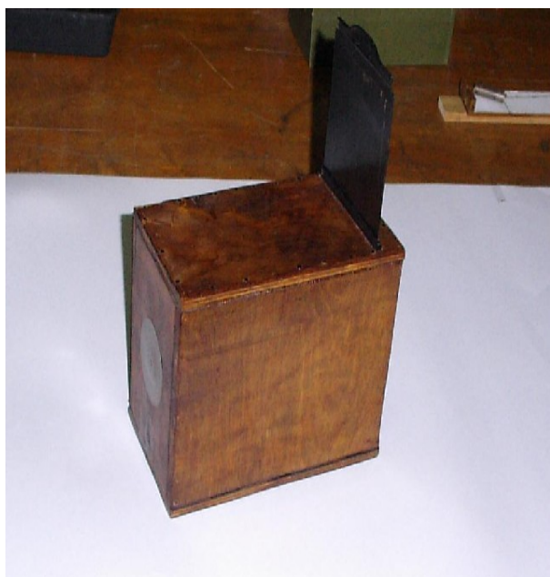
Рис.3. Камера-обскура, изготовленная в лаборатории физики Каменец-Подольского национального университета.
