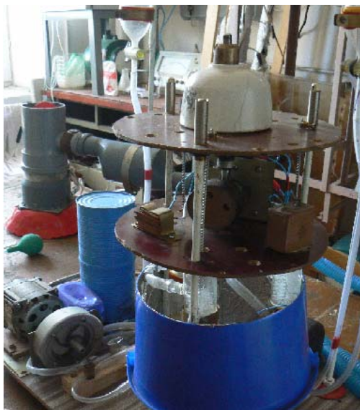
Рис.2. Общий вид пилотной фотокаталитической установки проточного типа для изучения процессов гидролиза биохимически труднодеградируемых веществ.
