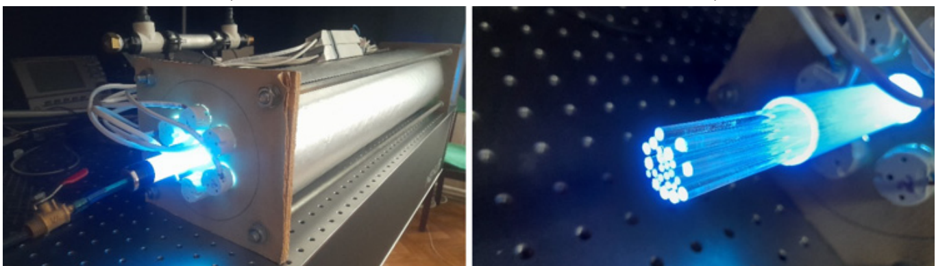
Fig. 2. Tubul de cuarț introdus în echipamentul de decontaminare ce conține 6 lămpi UVC.
